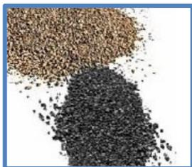
**Le média de conversion/polissage PEACEMAKER®** est imprégné d'une amine polymère brevetée et est utilisé dans des conditions élevées en H<sub>2</sub>S. L'élimination ne pose pas de problème lorsque le média est remplacé tel que recommandé par le fabricant.
