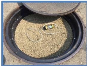
**Les épurateurs de regard PEACEMAKER®** pour contrôle des odeurs permettent de contrôler le H<sub>2</sub>S et d'autres odeurs tout en permettant une ventilation adéquate grâce au média de conversion PEACEMAKER®. Les récipients d'épurateur de regard en plastique ABS sur mesure sont efficaces, économiques, faciles à installer par une seule personne et ne nécessitent aucun entretien.
